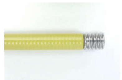
Laisser impérativement 6 ondulations nues pour raccord FLEXICLIC.
