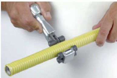
Coupe du tuyau FLEXIPIPE avec coupe-tube adapté.
