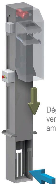
Dégrilleur automatique vertical à déversement amont.
