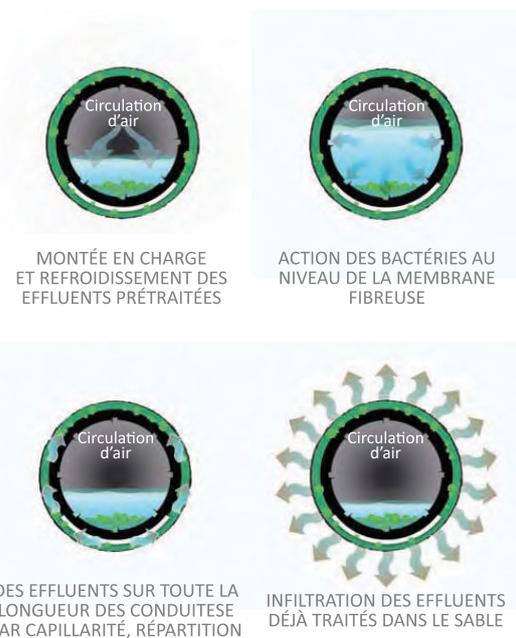
Le système Enviro))Septic est un dispositif de traitement sans mécanique, sans énergie, sans entretien permettant de gérer les à-coups hydrauliques.
