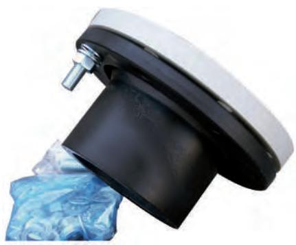
• Ensemble composé d'un collet en PE SDR 11, d'un anneau anti-fluage en PP, d'une bride en acier recouverte PP et d'un kit de visserie comprenant notamment une rondelle conique lisse qui permet de contrôler le serrage de la bride.
