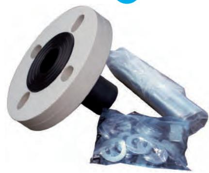
• Ensemble composé d'un collet en Pe 100 SDR 11, d'une bride anti-fluage en PP chargée de fibres de verre et d'un kit de visserie comprenant notamment une rondelle conique lisse qui permet de contrôler le serrage de la bride.
