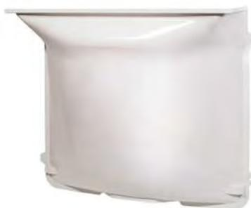
• Cour anglaise en composite renforcé de fibres de verre, couleur blanc avec ouverture dans le fond pour évacuation des eaux résiduelles. Équipée d'une grille en acier galvanisé à chaud maille 30/30. La cour anglaise est livrée avec tous les accessoires nécessaires à sa fixation..
