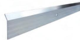
Le Fixnet 40 remplit la double fonction de protection et de fixation mécanique des relevés d'étanchéité. La partie haute de 10 mm permet d'accueillir un joint mastic sur chantier afin de rendre étanche le dispositif.
