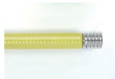
Laisser impérativement 6 ondulations nues pour raccord FLEXICLIC.
