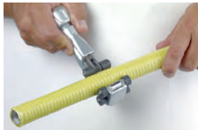
Coupe du tuyau FLEXIPIPE avec coupe-tube adapté.
