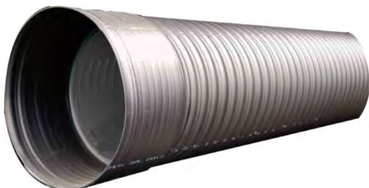
Tubes PEHD pour drainage, double paroi, intérieur noir lisse et extérieur noir annelé. Barre de 6 m avec manchon de jonction.
