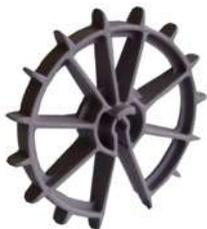
Cale plastique pour la mise en place du treillis dans un voile. Permet un enrobage à 30 ou 50 mm du bord du voile béton.
