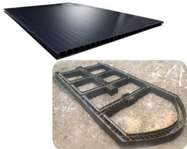
FUNDECO est une solution économique qui permet de coffrer les fondations avec un coffrage perdu. Ce procédé a pour but de **limiter la consommation** de béton. Les plaques de FUNDECO peuvent rester en place après bétonnage et **protéger le béton** de l'humidité.
