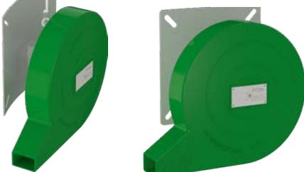
Le contrôleur de débit à effet vortex de type V2PHEM permet de maîtriser les flux hydrauliques sur les réseaux d'eaux pluviales en ne laissant passer qu'un débit de pointe souhaité pour une hauteur d'eau maximale donnée. Il s'installe en fosse humide et exige un écoulement libre en aval. Il est amovible en cas de besoin.
